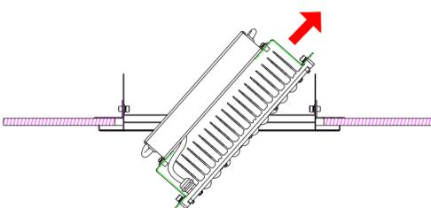
Aperte os parafusos entre a moldura e a chapa de fixação
